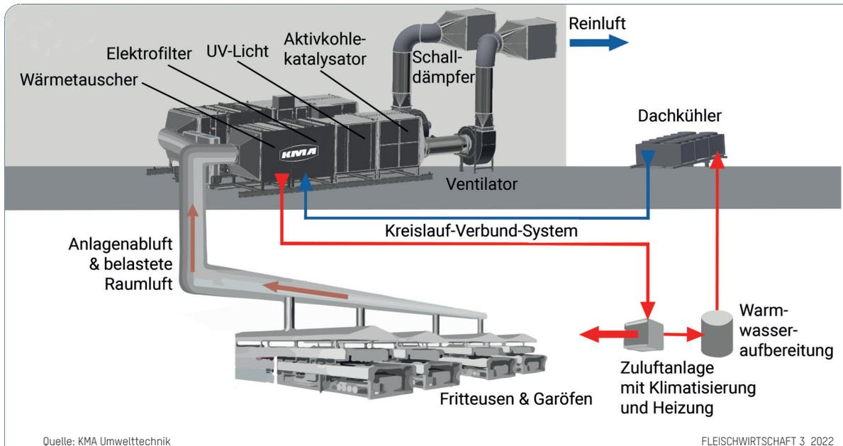
Im Rahmen einer Kapazitätserweiterung bei Tönnies wurde die Einbindung neuer Fritteusen und Garöfen in die Abluft- und Raumlufttechnik notwendig. Das nachhaltige KMA-Abluftfiltersystem (grauer Kasten) überzeugte mit einer deutlich besseren Energieeffizienz im Vergleich zu anderen Verfahren.
