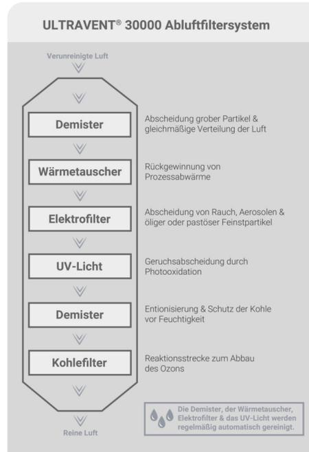
Das mehrstufige Filtersystem kombiniert Elektrofilter und UV-Licht für hohen Wirkungsgrad.
