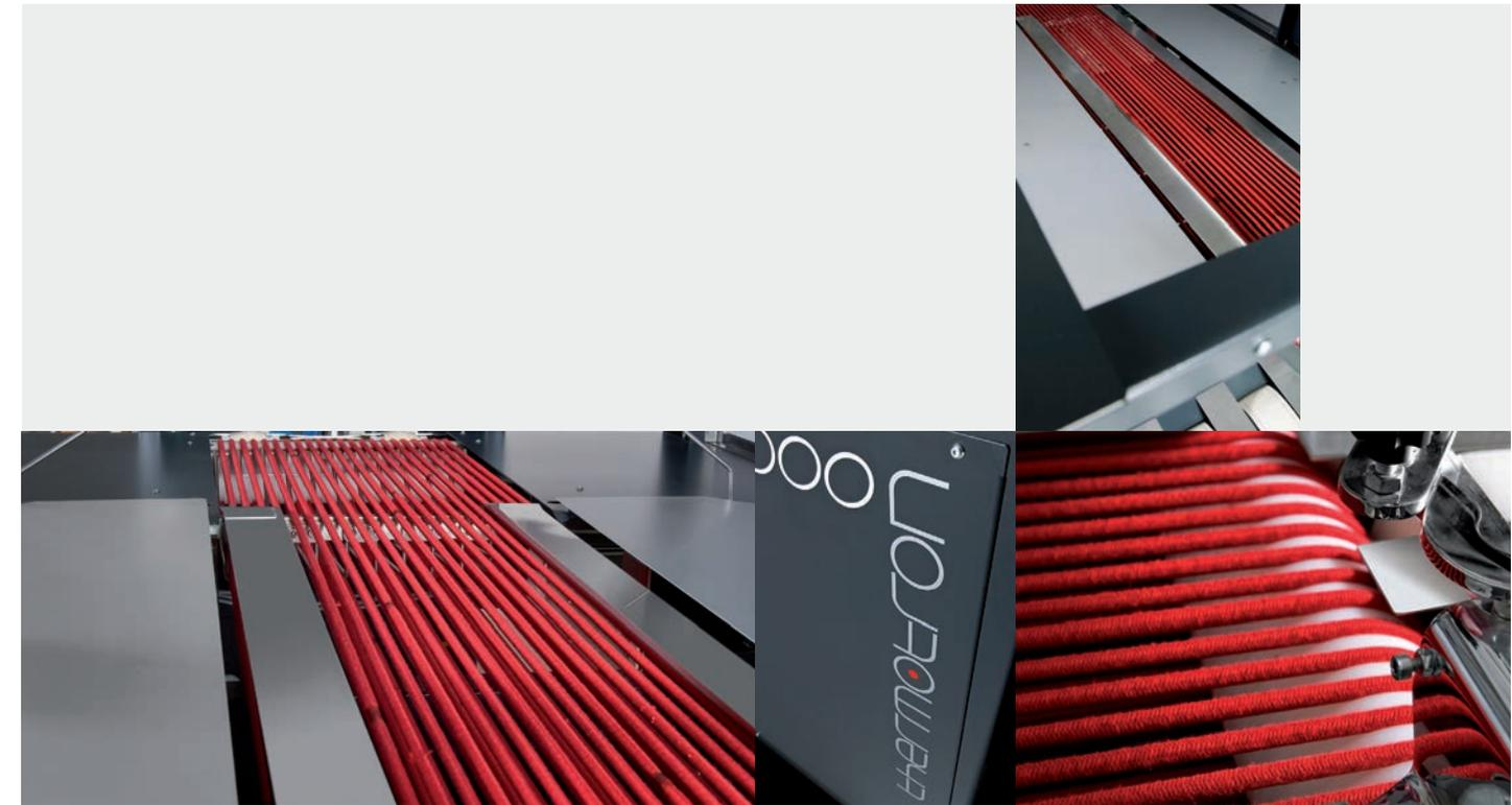
Die automatische Faltmaschine **STP1000\*** faltet Textilien schnell, leise und präzise. Für die Bedienung der Maschine, die auf optimale Art und Weise T-Shirt faltet, genügt eine Person. Ein einfacher Regulator erlaubt das Falten von Textilien unterschiedlicher Art und Größe auf verschiedene Weise.
