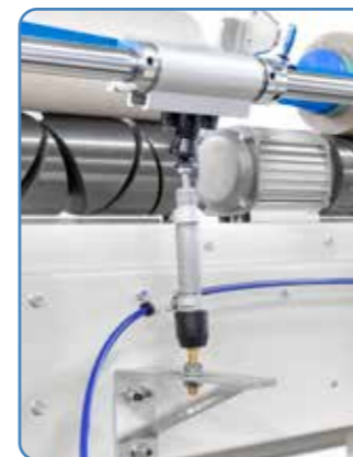
Contrappesatura pneumatica. Pneumatic counterweight. Contrapeso neumatico. Contrepoids pneumatique. Pneumatisches Gegengewicht.
