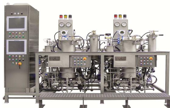
**La macchina AcquaZero® per la tintura di tessuti su subbio** stabilisce nuovi standard nella tintura di tessuti naturali e sintetici (includendo fibre aramidiche e poliammidi ad alta densità), nonché di tessuti a maglia e navetta.
