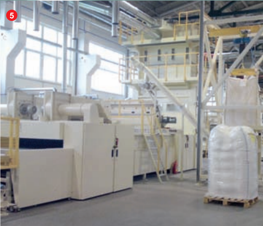
AIRLAY “FELTECH” WITH RESIN DISTRIBUTOR NAPADORA NEUMÁTICA “FELTECH” CON APLICADOR DE RESINA
