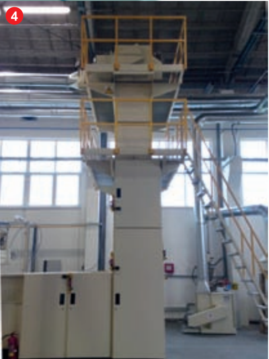
AUTOLEVELER HOPPER FEEDER MODEL CNA WITH CONTINUOUS WEIGHING CONTROL CARGADOR AUTOREGULADOR MODELO CNA CON SISTEMA DE CONTROL DE PESO EN CONTINUO
