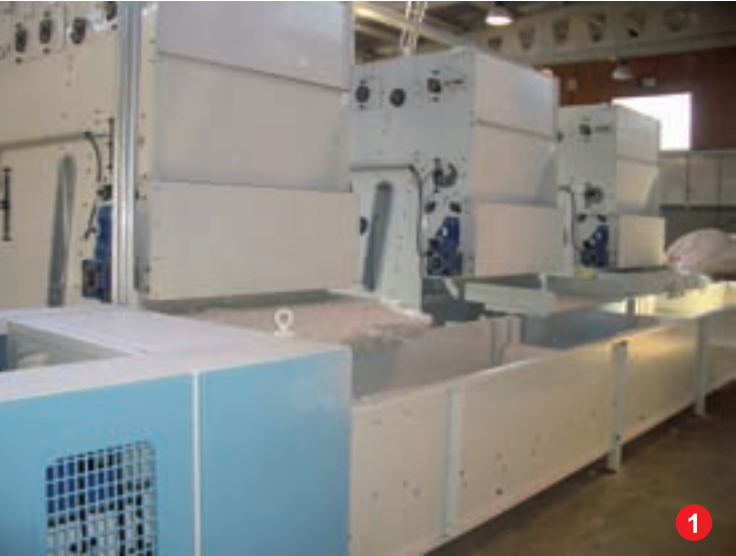
BLENDING LINE WITH CONTINUOUS WEIGHING BALE OPENER “AP TYPE” TO WORK WITH ANY KIND OF FIBRES LÍNEA DE MEZCLAS CON ABRIDORAS DE BALAS CON PESADO EN CONTINUO “MODELO AP” PARA TRABAJAR CON CUALQUIER TIPO DE FIBRAS
