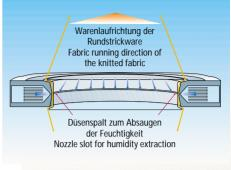
Funktionsprinzip der Suchy-Ringsaugdüse. Principle of the Suchy-circular extraction nozzle.
