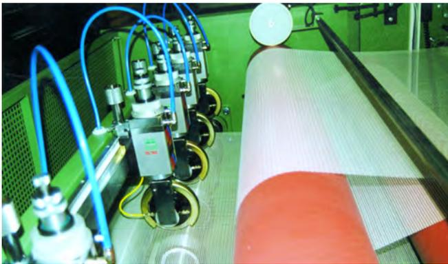
Die SUCUT-Schneidemaschinen sind bestens geeignet zum Längs- und Quertrennen von Warenbahnen unterschiedlichster Qualitäten. Es können je nach Materialart und -zusammensetzung verschiedene Schneidverfahren (z.B. Klingen-, Quetsch- und Ultraschallschnitt) sowie Werkzeuge (Schlag-, Band- oder Rundmesser) zur Anwendung kommen.
