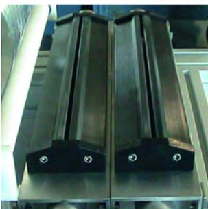
Über der Saugrohrbaugruppe befindet sich eine Spezialschlitzdüse, deren Geometrie der Garant für niedrige Restfeuchtwerte ist.
