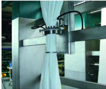
Die vorgelegte Schlauchware wird auf kürzest möglichem Weg ausgedreht, geöffnet und mit der Passage der Ringsaugdüse über den gesamten Schlauchumfang gleichmäßig, schonend und effektiv vakuumentwässert.
