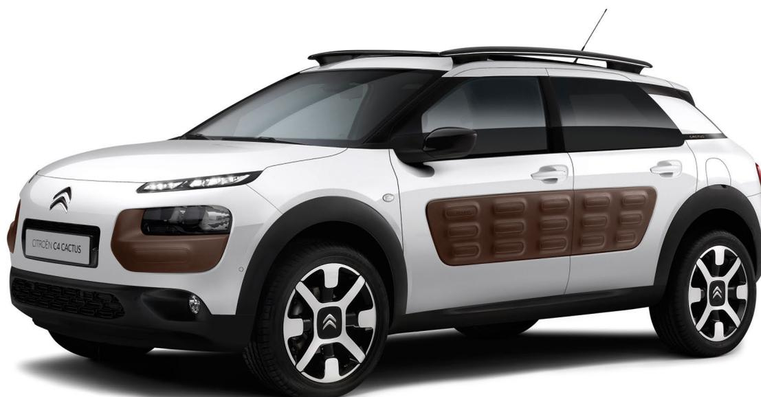
Der Citroën C4 Cactus mit großformatigen, kontrastfarbigen Luftkissenträgern an den Seiten sowie an Front und Heck
