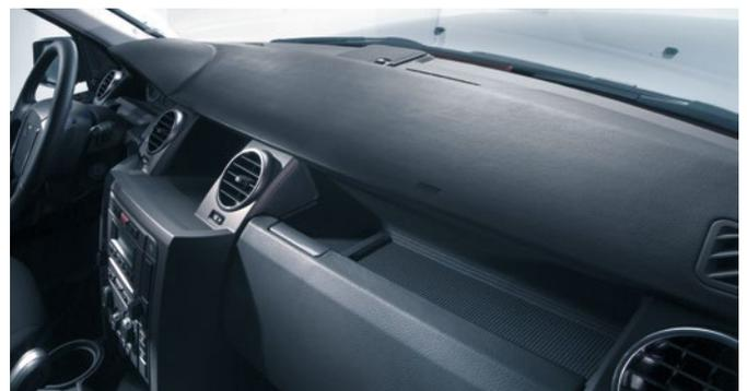
Hochwertige Oberflächen aus Elastollan®: Die Slush-Haut dieser Armaturentafel besteht durch exzellente Lichtbeständigkeit, geringe Dichte sowie gute Tieftemperatureigenschaften
