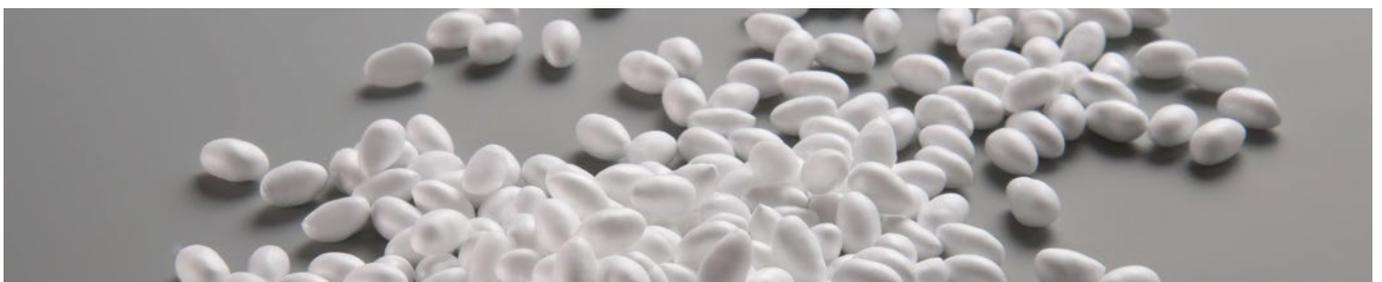
Die einzelnen Infinergy®-Partikel haben eine Größe von 5 bis 10mm und werden mit einer Schüttdichte von durchschnittlich 110kg/m³ ausgeliefert
