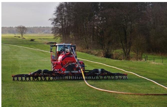
Durch eine hohe Abriebfestigkeit und Flexibilität, gute Ozon-, UV- und Güllebeständigkeit sind Schläuche aus Elastollan® zudem bestens für den Einsatz als Schleppschläuche in Agrar- anwendungen geeignet, Foto: Jakob Eschbach GmbH
