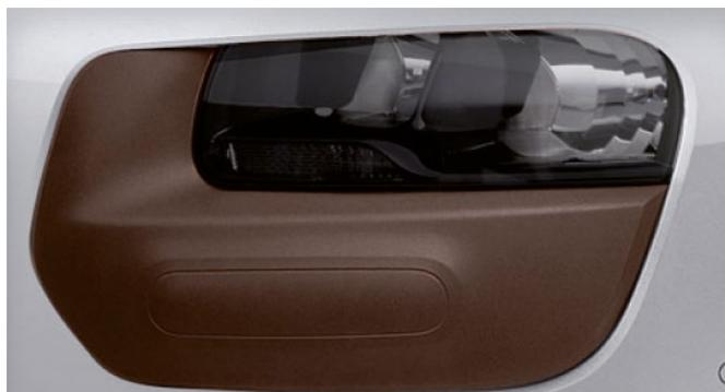
Die Airbumps® von PSA Peugeot Citroën sind aus kratzfestem, UV- und witterungsbeständigem Elastollan® AC 55D10 HPM gefertigt
