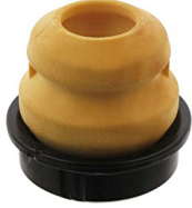
Süspansiyon Takozu (Ön) Jounce Bumper (Front)
