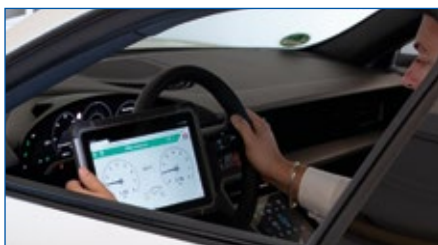
C_Tablet-PC Rugged (Industrie- und Militärstandard)
