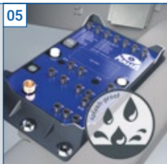
05 Vergossenes, spritzwassergeschütztes und nahezu wasserdichtes Interfacemodul
