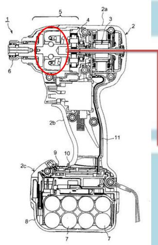
電動工具零件-錘擊塊
