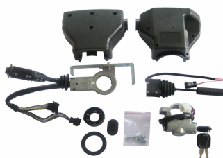
D组合开关 JK338-AW2 (含排气制动开关) 3711-00039
