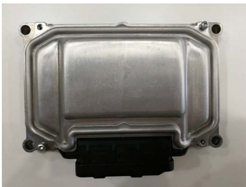
图 2-1 V3 整车控制器的正面外型结构
