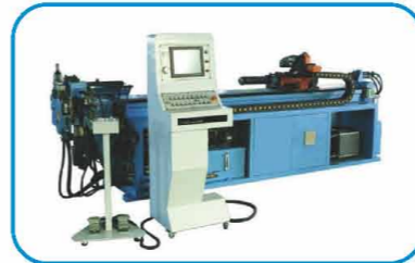
CNC折弯机：12台 CNC bending machines : 12 units
