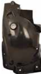
Taliant 21-> Logan III Sandero 21-> Çamurluk Davlumbazı Önün Arkası Sol Taliant 21-> Logan III Sandero 21-> Front's Rear Left Inner Fender
