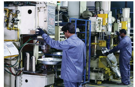
Projection Welding 175 Kva ~ 250 Kva
