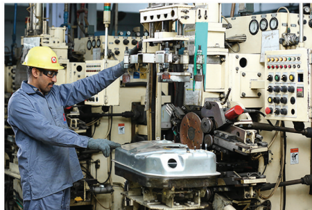
Seam Welding 120 Kva ~ 200 Kva
