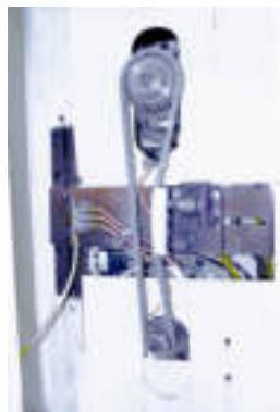
**封闭式链条耐磨试验机**
