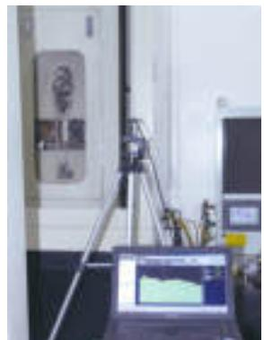
**正时链系统噪声试验台**
