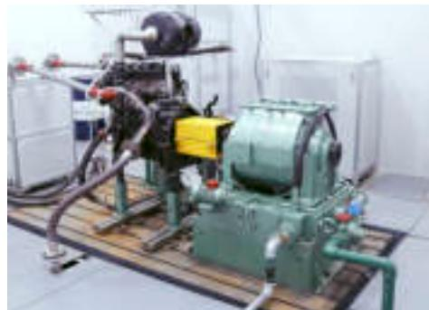
**电涡流测功机试验台架系统**
