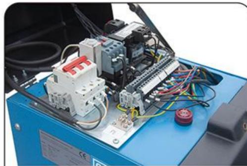
控制柜电器部分模块化，24V安全电源，方便后期维护维修
