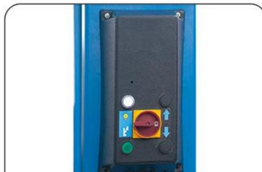
24V安全电源，控制柜电器部分模块化，方便后期维护维修
