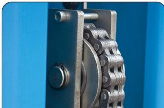
主链条轮采用双滚柱轴承设计，全密封状态，无需注油，永久免维护
