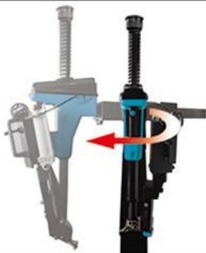
旋升侧摆立柱设计，行业内唯一具有此类产品的企业，集后倾式轮胎拆装机与摆臂式轮胎拆装机的优点于一身
