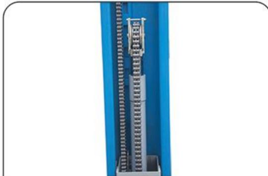
采用链条调平，避免钢丝绳延展、断裂带来的安全隐患和更换烦恼
