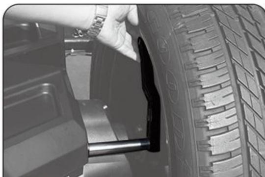
电子感应内部拉尺自动获取车轮参数并切换平衡模式
