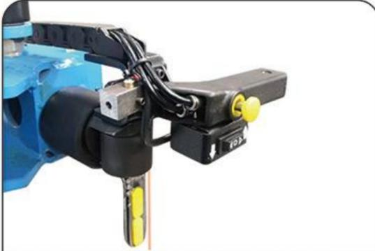
装胎头双滚轮设计，配有保护套和激光指示
