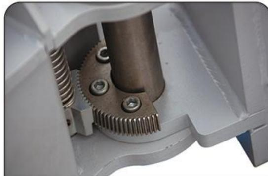
托臂自锁机构，配加密锁齿
