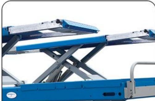
二次举升平台核载4吨，可分两段抽拉延伸，适合不同轴距车辆
