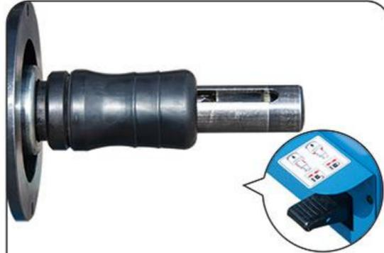
气动锁紧主轴，夹紧轮辋快速，力量均匀，提高平衡精度
