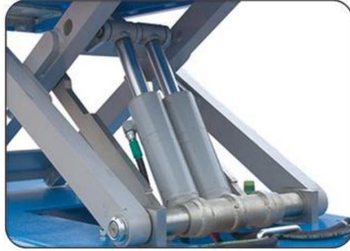
整机意大利团队设计，采用双油路8油缸设计，配置双电机双泵站，主机无任何电线及电器原件与控制柜连接
