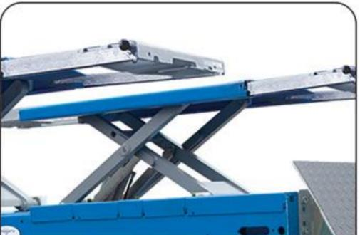
二次举升平台核载4吨，可分两段抽拉延伸，适合不同轴距车辆
