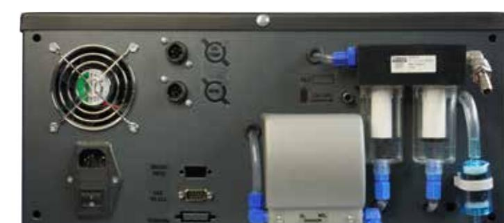
Dettaglio del retro dell'analizzatore con prese di alimentazione e connessione, filtri, tubo sonda.
