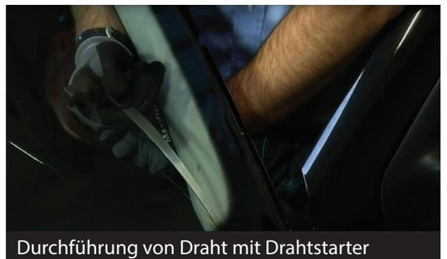
Durchführung von Draht mit Drahtstarter
