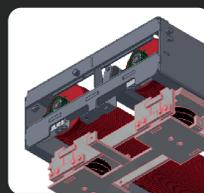
**Rollensatzanhebung pneumatisch** mit Gleitführung für BPS Compact XT-4220 – XT-6280: Hubkraft max. 2,5 t Achslast
