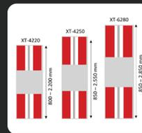
**Rollensatz-Varianten** bzw. Sonderanpassung der Prüfstandsmechanik an vorhandene Fundamente
