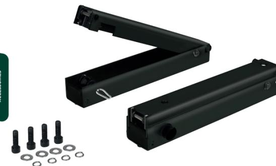
Ermöglicht das Abklappen der Deichselträger BC260 zum ungehinderten Öffnen des Staufachs am Caravan. Der Abklapp-Adapter wird zwischen Schiebemechanismus und Fahrradträger befestigt. Die Verriegelung wird mittels eines Seiles, das zwischen den Abklapp-Adapter befestigt ist, gelöst und der Fahrradträger klappt auch im beladenem Zustand nach oben.
