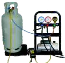
Unsere Füllstationen sind alle mit einer elektronischen Waage und einer Vakuumpumpe ausgestattet. Alles zusammen, einschließlich der Füllschläuche, ist in einem Rahmen befestigt und somit ideal für den mobilen und stationären Einsatz geeignet.
