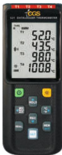
Kabelloses 4- KanalThermometer mit Data Logger und Bluetooth Messung und Aufzeichnung von 4 Temperaturen gleichzeitig 32.000 Speicherpunkten Übertragung der Daten über Bluetooth oder USB Kabel zum PC oder Smartphone Real Reading und graphische Afzeichnung Windows Software, Standart 2x TPK01 auf andere Fühler möglich
