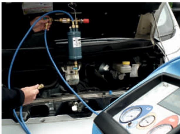
Schutzfilter mit Konstantdruck- Regler Typ SGLAS-FLUSH
