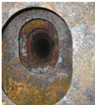
Vorbehandlung mit FLUID FILM Liquid A mit 25 µm (wff.)
