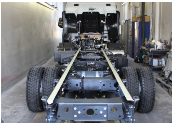
IVECO Hamburg - die Fahrzeuge werden ab Werk mit HODT MULTI FILM konserviert
