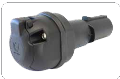
Adapter / Spannungsreduzierer 24V > 12V - Verbindet fahrzeugseitige 7P/24V Steckdose (ISO 1185) mit anhängerseitigem 7P/12V Stecker (ISO 1724) Adapter / Voltage Reducer 24V > 12V - Connects 7P/24V socket (ISO 1185) on vehicle side with 7P/12V plug (ISO 1724) on trailer side
