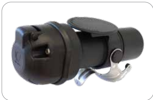
Adapter / Spannungsreduzierer 24V > 12V - Verbindet fahrzeugseitige 15P/24V Steckdose (ISO 12098) mit anhängerseitigem 7P/12V Stecker (ISO 1724) Adapter / Voltage Reducer 24V > 12V - Connects 15P/24V socket (ISO 12098) on vehicle side with 7P/12V plug (ISO 1724) on trailer side
