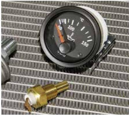
Die Skala des typischen Öltemperatur-Instruments reicht von 50 bis 150 Grad. Die Uhren gibt es in verschiedenen Designs und in Kombination mit unterschiedlichen Gebern, hier als Öllablassetraube ausgeführt
