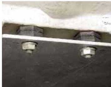
Ölkühler sollten wie Wasserkühler möglichst elastisch aufgehängt werden
