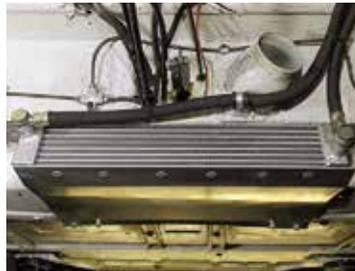
Maßgeschneiderte Anlage am Beispiel eines getunten Fiat 500 im Abarth-Stil: Der Unterflur-Ölkühler sitzt vor dem Motor (l.) über einem Luftleit- und Schutzblech
