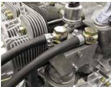
Beispiel VW-Bus: Beim Typ-4-Motor wird der Original-Ölkühler durch einen Anschlussblock (l.) mit Thermostat ersetzt. Die Leitungen liegen geschützt am Längsträger
