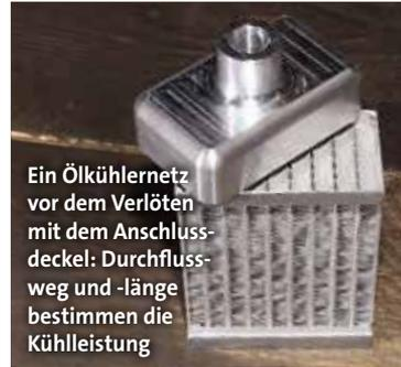
Ein Ölkühlernetz vor dem Verlöten mit dem Anschlussdeckel: Durchflussweg und -länge bestimmen die Kühlleistung
