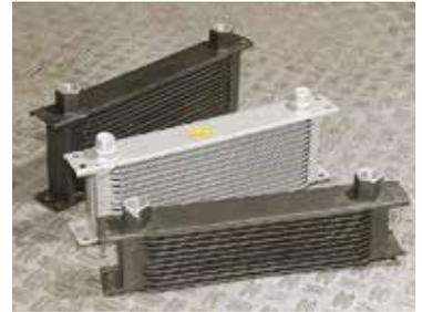
Häufig werden solche Kühler von 330 Millimetern Länge verwendet
