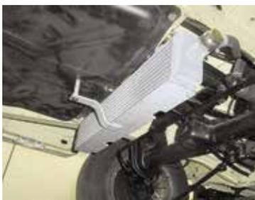
Der niedrige, breite Ölkühler sitzt von außen unsichtbar hinter der Vorderachse
