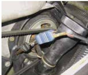
Ganz klassisch: Ein Geber mit Kapillarrohr wird in die Ölwanne eingeschraubt. Einfacher ist ein elektrischer Ölpeilstab-Sensor (r.)
