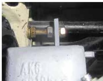
Idealerweise fertigt man Halter an, um vorhandene Bohrungen zu nutzen
