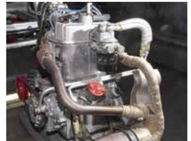
Für den Anschluss der Ölleitungen wurde das Motorgehäuse modifiziert
