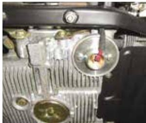
Für VW-Typ-4-Boxer gibt es bei *Kummetat* diesen Flansch mit Thermofühler, den man anstelle eines Blechdeckels ins Gehäuse schraubt
