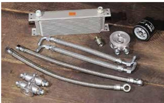
Dieser Standard-Ölkühler-Einbausatz mit Adapterplatte und Schlauch-Thermostat (oben) muss nur noch angeschraubt werden. Rechts: Montagebeispiele mit Thermostatadapter (hinten) und Ölfilter-Verlegungsadapter
