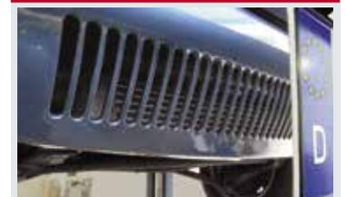
Oft ist es wünschenswert, den Ölkühler unsichtbar zu platzieren. Die Position hinter der geschlitzten Frontschürze ist prinzipiell ideal. Pech allerdings, wenn dann das Nummernschild so montiert wird, dass es den Luftstrom absperrt.
