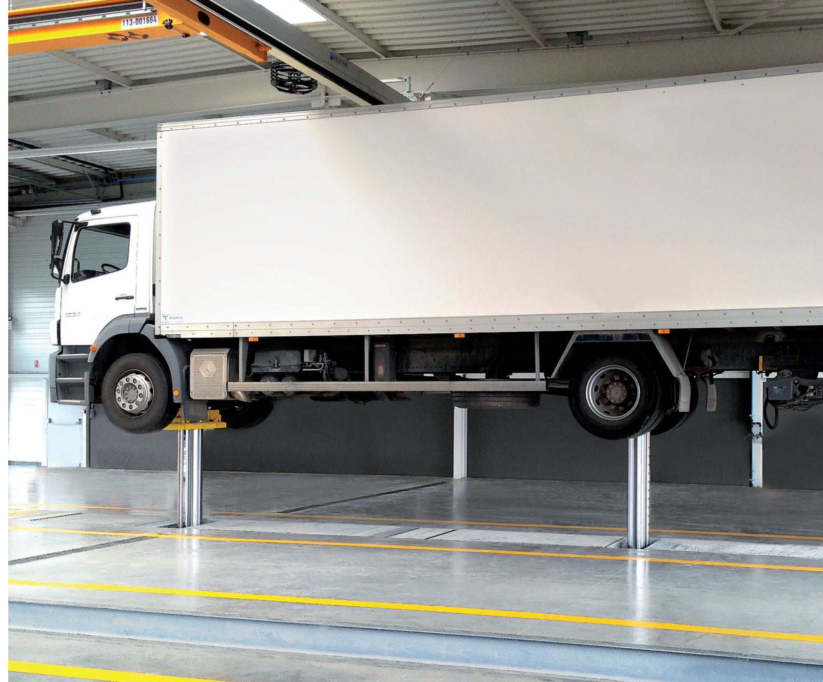
Abbildung: Zwei-Stempel-Hebebühne Tragfähigkeit: 16.000 kg pro Hubeinheit.
