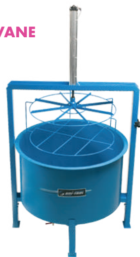
Skúšobná vaňa PNEUBAD-1 Objem vody: 300 l Max. šírka kolesa: 18"
