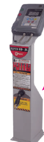
Stojanový hustič HJ931BD-JX - so samonavijacím bubnom Dĺžka hadice: 10 m Rozsah hustenia: 1-7 bar / 7-13 bar
