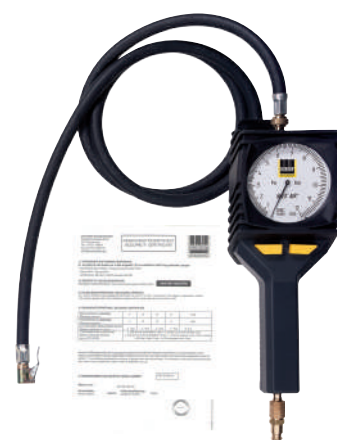
Hustič Schneider RF-12-MG Dĺžka hadice: 2,5 m Merací rozsah: 0,7 - 12 bar
