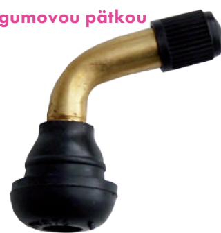
Ventil TR 412 L scooter ø otvoru v disku: 11,3 mm Dĺžka: 32,5 mm
