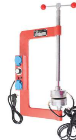
Vulkanizačná zvierka TW-440S Pre: radiálne plášte do š. 12R 609,91 10.101
