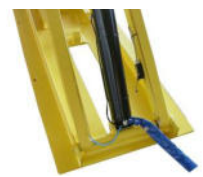
Stoppeinrichtung für endgültiges Senken. Akustisches Signal während dem Senken.
