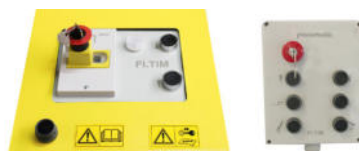
Notausknopf mit abschließbarem Gehäuse gegen unbefugte Benutzung
