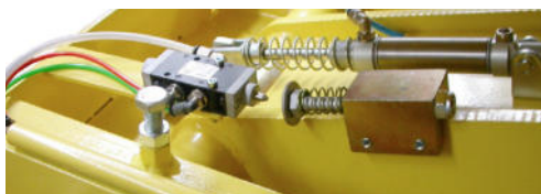
Sicherheitseinrichtung, die Hebebühne stoppt nach ausfahren aus dem Fundament zum Schutz vor Beschädigung am Unterboden eines Fahrzeugs
