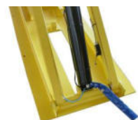
Stoppeinrichtung für endgültiges Senken mit akustischem Signal
