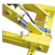
Stoppeinrichtung für endgültiges Senken Akustisches Signal während dem Senken
