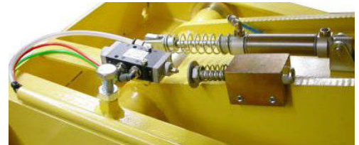
Sicherheitseinrichtung, die Hebebühne stoppt nach ausfahren aus dem Fundament zum Schutz vor Beschädigung am Unterboden eines Fahrzeugs
