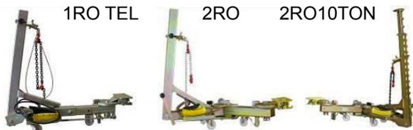
3 verschiedene Zuggerät Modelle, welche an jedem Punkt um die Hubplattform montiert werden können
