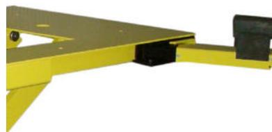
Die teleskopierbaren Hubarme sind innerhalb der Stellfläche des Fahrzeugs, zur Sicherheit von Personen, die in der Nähe des Fahrzeugs arbeiten
