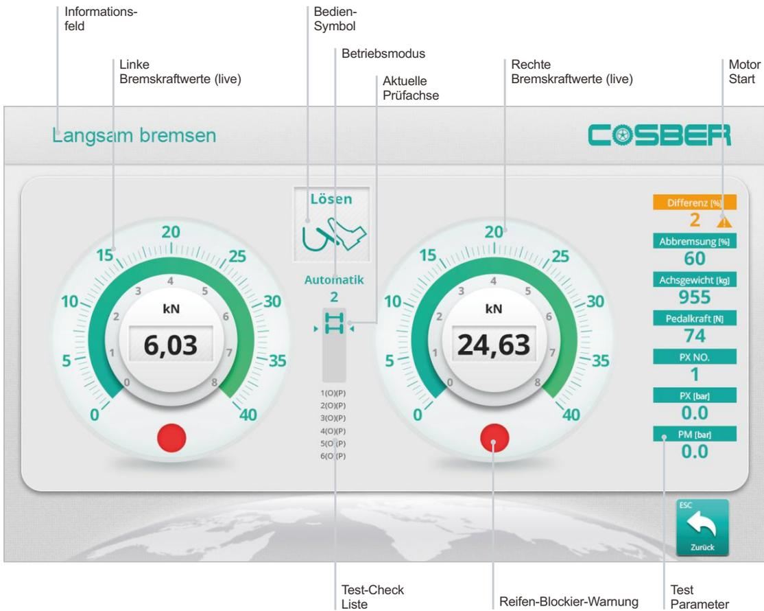
Cosber Bremsprüfstandssoftware – Prüfbildschirm
