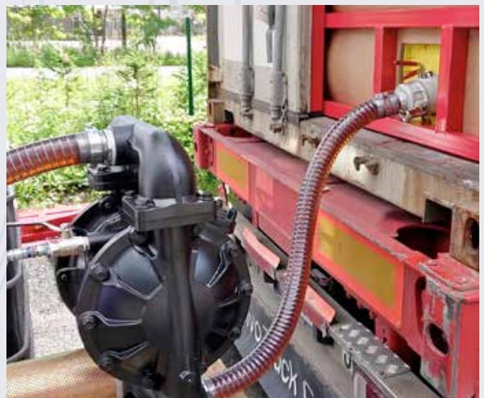
Hohe Flüssigkeitsviskosität reduziert die Förderleistung der Pumpe.
