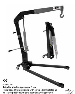
CAPACITY MAXIMUM HEIGHT 1000kg 334mm 2120mm 750kg 214mm 2210mm 500kg 94mm 2300mm
