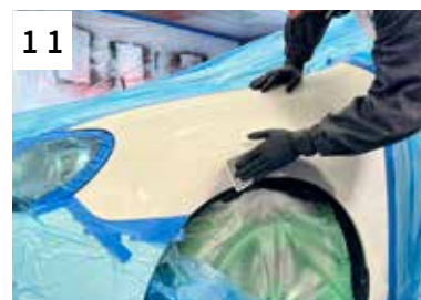
11 Schleifen mit P400 bis P600 Randzone mit P1000 + P2000
