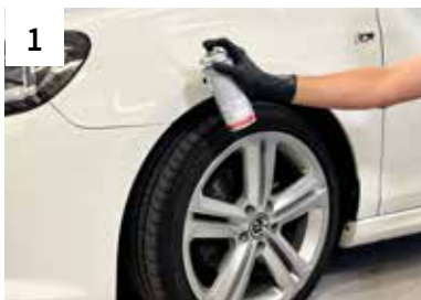
1 Schadstelle reinigen mit 1K Silikon-Entferner
