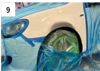
9 Ablüften (ca. 5 Min zwischen den Spritzgängen)
