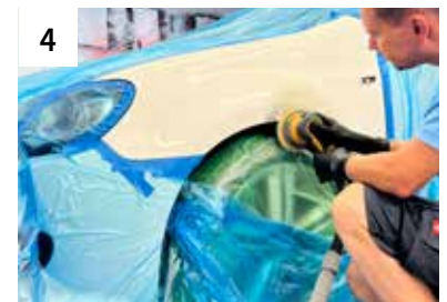
4 Schadstelle schleifen maschinell P80- P240 Randzone P320-400
