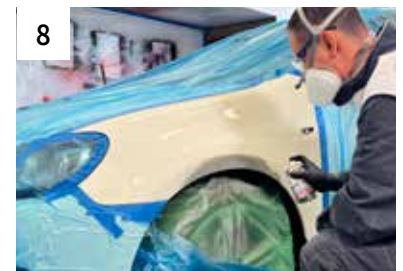
8 Grundieren mit 2K Acryl- Schleiffüller (2-3 Spritzgänge)
