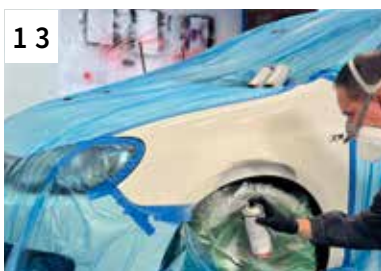
13 Basislack applizieren (je nach Deckkraft 2-3 dünne Spritzgänge)
