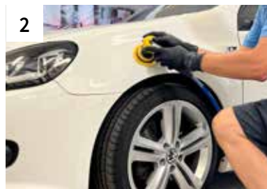
2 Zu lackierende Fläche großzügig polieren
