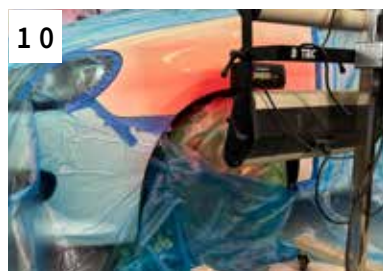
10 IR Trocknung, ca 25 Min bei 40 cm Abstand
