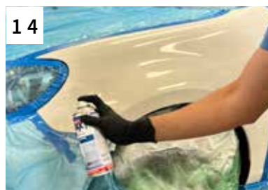
14 2K Klarlack applizieren (2 Spritz- gänge mit Zwischenablüften)
