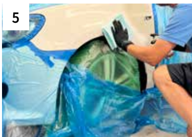
5 Reinigen mit 1K Silikon- Entferner
