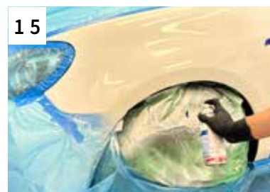
15 Auf Randzone Beispritzverdün- nung applizieren
