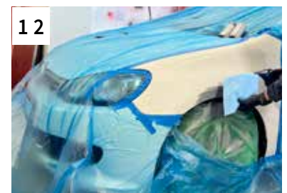
12 Reinigen mit 1K Aqua-Silikon- Entferner
