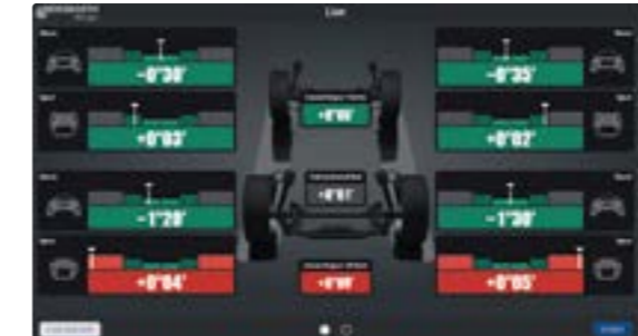
Achsvermessung mit Q.Lign
