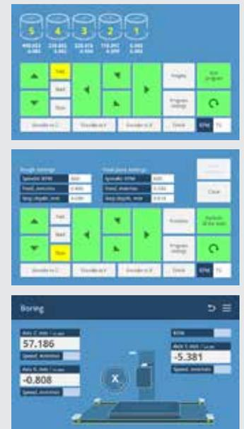
L'alesatrice/spianatrice ACF200.CNC riunisce le due principali operazioni di ricondizionamento dei monoblocchi di vetture e camion, quali alesatura e spianatura, in un'unica macchina e da ora in maniera totalmente automatica grazie al controllo CNC.
