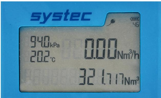
deltawaveSUF ist ab Werk komplett parametrierbar und kalibriert. Die Bedienung über 4 Tasten ist verplombt, um deltawaveSUF auch für Abrechnungen sicher zu machen.
