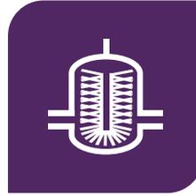
Es gibt verschiedene Varianten von Drahtgeflechten: horizontal oder vertikal, mit oder ohne Mittelkern, in Form einer Spirale, einer Bürste oder eines Siebs.
