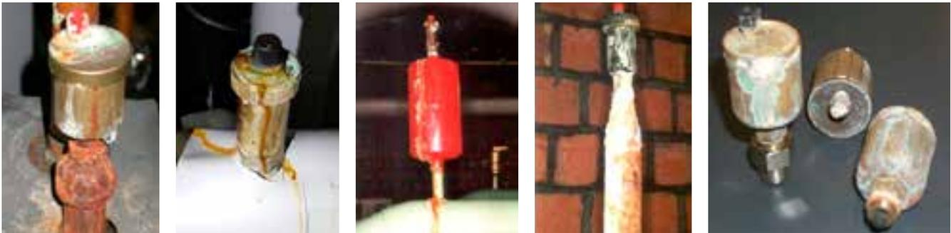
Beispiel für minderwertige Entlüfter, die aufgrund ihrer mangelhaften Konstruktion bald undicht werden
