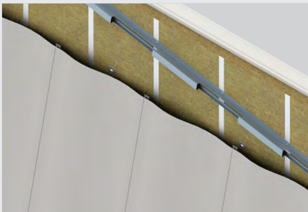
Hinterlüftete Fassade – schräg auf Kassetten- Innenschale mit vorgesetzter Dämmung
