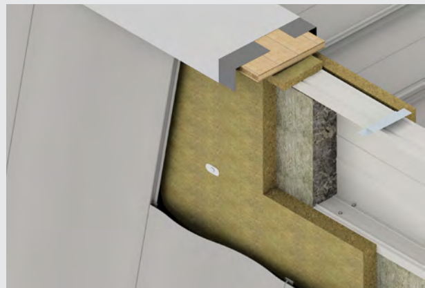
Oberer Fassadenabschluss – schräg auf Kassetten- Innenschale mit vorgesetzter Dämmung
