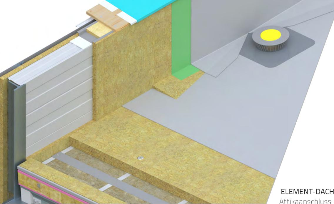
**ELEMENT-DACH MIT DACHABDICHTUNG**
