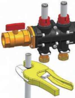
水平切割管道 Cut pipe horizontally
