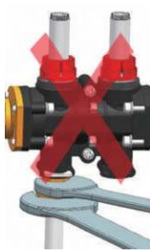
不要将带有适配器的管子， 连接至分水器固定 Do not connect the pipe with adapter to manifold before fixing it!
