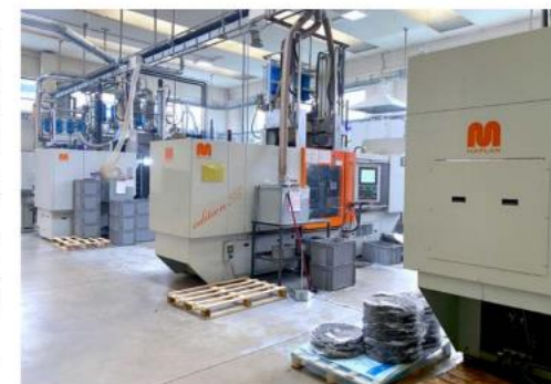
Presses Maplan in A.T. Gomma. A partire dal 2016 l'azienda ha cominciato a introdurre questi nuovi macchinari, dotati di sistema a iniezione FI-FO, in sostituzione di quelli vecchi.
