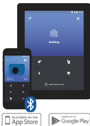
Über Bluetooth können mit einem Smartphone oder Tablet über die dxlink App (Android und IOS) sämtliche Parameter wie z.B. Soll- und Ist-Wassermengen, Spülfunktion, Bus-Adressierung, anstehende Regelsignale, usw. eingestellt und ausgelesen werden. Modbus und BACnet können einfach umgeschaltet werden.
