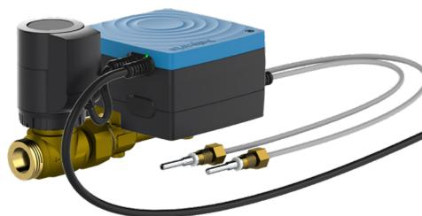
Regelventile der Baureihe iQ können mit zwei Temperatursensoren zur Messung der Vor- und Rücklauftemperatur ausgestattet werden. Über die beiden Temperaturen T1 und T2, zusammen mit dem Durchfluss ( $V_{am}$ ), wird die an den Raum abgegebene Wärmeleistung berechnet und ermöglicht Energie-Monitoring auf Einzelraum-Basis.
