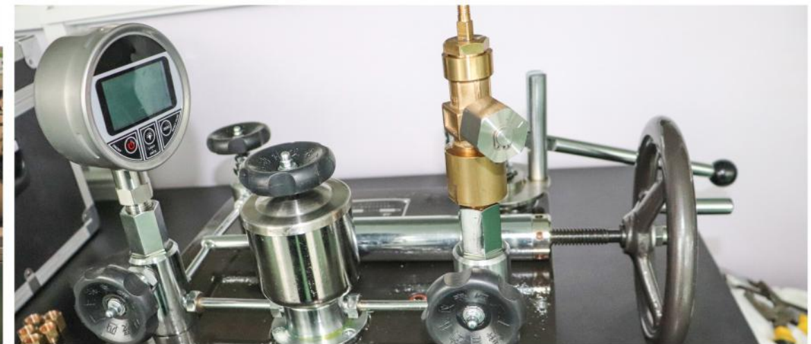
压力表校验器 Pressure gauge calibrator
