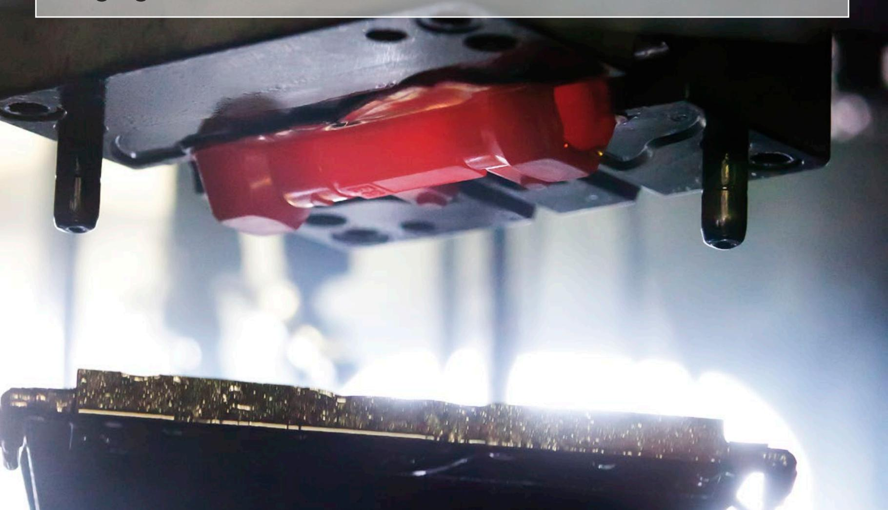
Il reparto di stampaggio è dotato di presse automatiche a gestione elettronica in grado di produrre articoli di diversi pesi e dimensioni per i più svariati settori. L'alta qualità dei prodotti ottenuti è garantita da pirometri ottici che permettono il controllo e la registrazione della temperatura di stampaggio.
