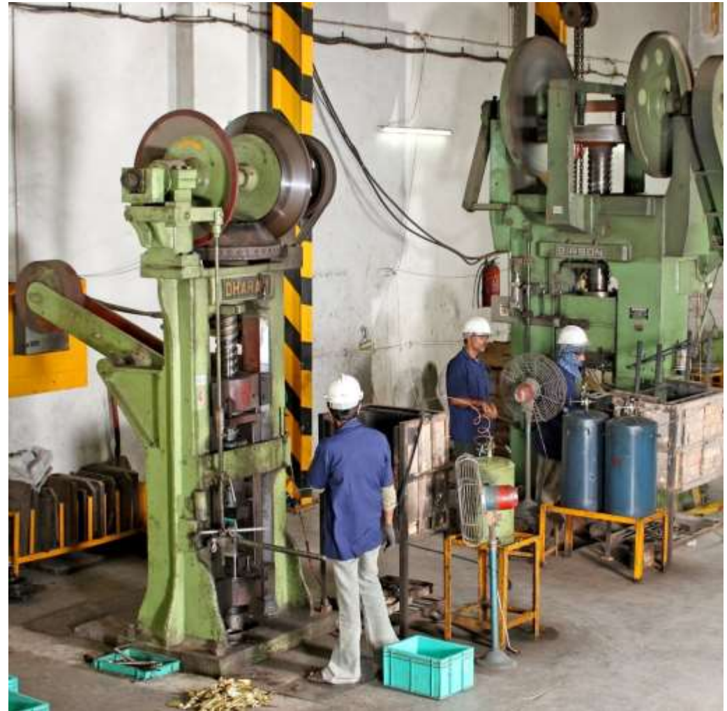
Forging Press : 150 ton to 300 ton. Capacity : 5000 strokes/day
