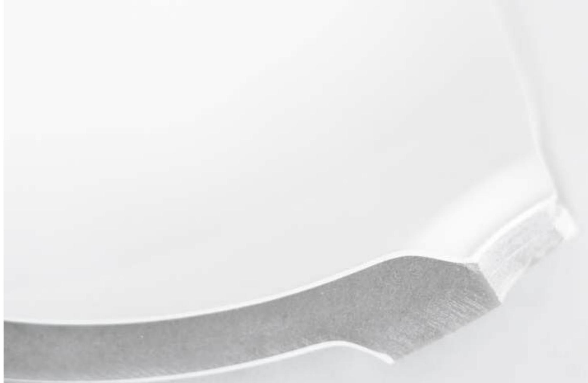
**M**ineralmarmor ist ein Material mit homogener Struktur, das aus mineralischen Bestandteilen, Dolomitmehl und Polyesterharzen hergestellt wird. Die auf seiner Basis entwickelten Produkte haben eine Außenschicht aus Polyester gelcoat. Dank der Kombination von natürlichen Mineralien und Harz ist extrem fest und widerstandsfähig gegen Beschädigungen.
