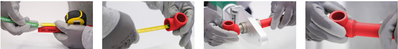
La unión soldada de tubo-accesorio no es compatible con la aplicación de adhesivos ni tubo roscado. Para proceder a efectuar la unión por termofusión se requiere máquina de polifusión manual o máquina de polifusión de banco en función del diámetro a soldar así como matrices polifusoras correspondientes. Con la ayuda de dichas herramientas se efectúa el calentamiento y la posterior unión del tubo-accesorio o accesorio-accesorio.
