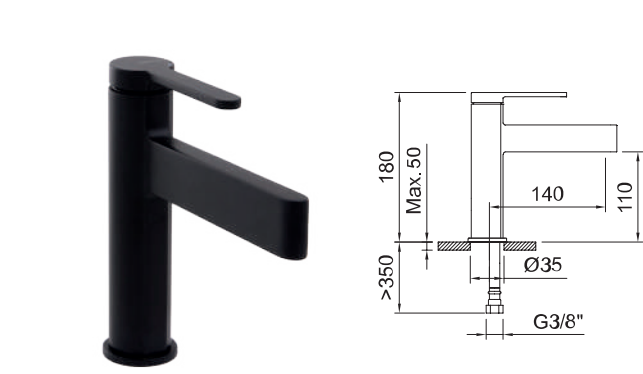
Lavabo monomando con aireador y flexibles 3/8" >350mm. Single-lever basin mixer with aerator and flexible hoses 3/8" >350mm. Mitigeur lavabo avec aérateur et flexibles de raccordement 3/8" >350mm.
